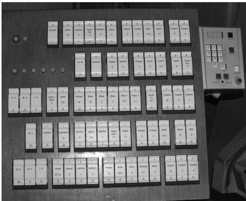
Registerpult von 1969, rechts angebrachter Schaltkasten für die computergesteuerte Setzeranlage von Martin Wolf
